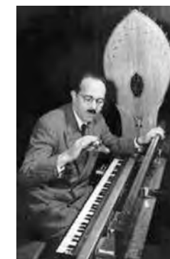
Ondes Martenot und ihr Erfinder Maurice Martenot. Das einstimmige elektronische Instrument auf der Basis von Differenzschwingungen wurde 1928 in der Pariser Oper erstmals einem begeisterten Publikum vorgestellt.
